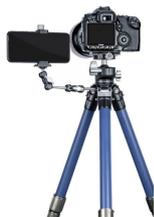
Ce trépied LP-284C peut atteindre une hauteur maximale de 129 cm et minimale de 16 cm. Il peut supporter une charge de 10 kg maximum. Ses quatre pieds sont faits de carbone : ce qui le rend léger mais solide : sa masse est de 1,55 kg. Une rotule LH30 est livrée avec le trépied : elle vous permettra de tourner à 360° afin de prendre vos plus belles photos. Une plaque de connexion BPL50 est livrée et est compatible avec la plaque de connexion Arca Swiss.
