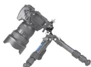
La rotule MBC-20 est une tête sphérique très petite et compacte. Elle a une base de trou de vis de 1/4 pouce afin de pouvoir la monter sur un mini-trépied. Son matériau est l'aluminium aéronautique anodisé noir : elle est donc légère (104 g) et très solide. Elle peut supporter une charge de 8 kg. Dimensions : 71x54x38.
