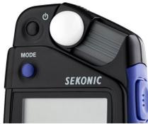
Le Sekonic L308X est un flashmètre portable et polyvalent qui combine les fonctions photo et vidéo en une seule unité. Le L308X est capable de mesurer la lumière incidente ou réfléchie via une lentille avec un angle de réception de 40°. Il offre une large plage de mesure de 0 à 19,9 EV à 100 ISO, en travaillant avec des temps d'exposition aussi bas que 1/8000 jusqu'à 60 secondes; il a également une portée de flash tout aussi large de f / 1.0 à f / 90.9 à 100 ISO.
